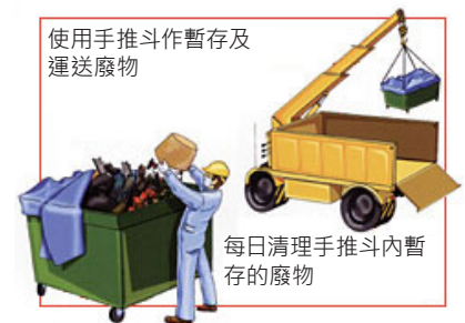
圖 125 使用手推斗作暫存及運送廢物 (來源: 環境保護署)
