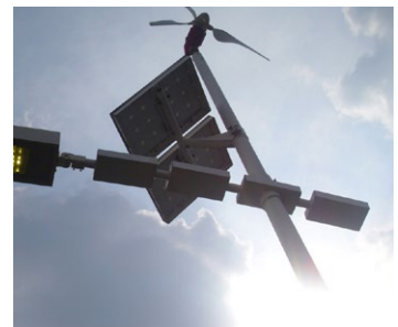
圖 118 風能/光伏（PV）混合式LED戶外燈具
