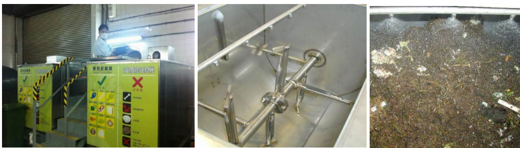
圖 164 廚餘堆肥裝置（來源：啟勝管理服務有限公司）
