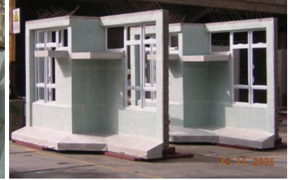
圖 124 預製建築外牆
